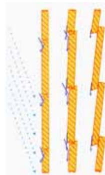
Richtig: Wasser fliesst ab.
